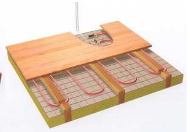
Onder een houten vloer
